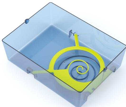
4. Remplacez le couvercle du bac sur la base. Assurez-vous que l'ouverture pour la tete de mesure se trouve juste au-dessus de la cible en spirale.
