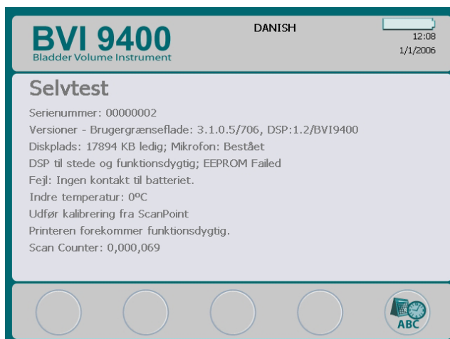
Figur 7. Skærbilledet Selvttest og Udskriv, når EEPROM har fejlet
