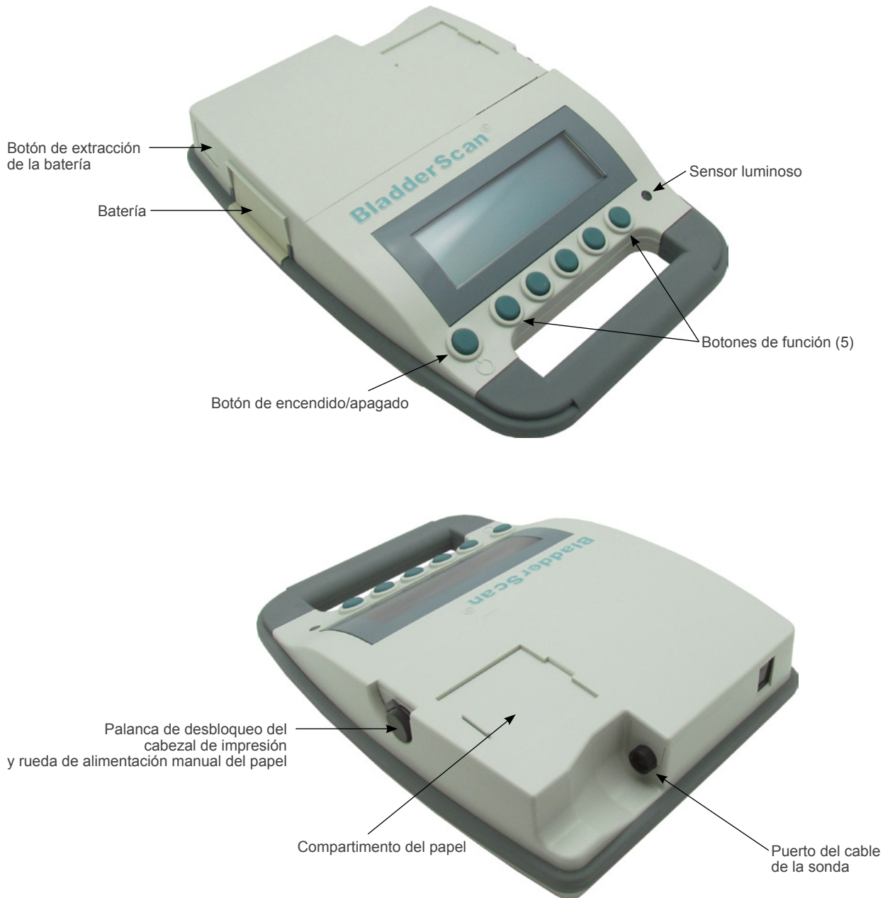
Figura 2. Componentes de la unidad de control
